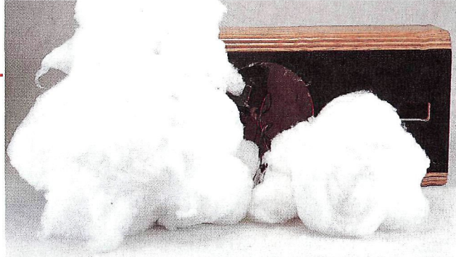
L'assorbente acustico è acrilico in grande quantità. Il midrange emette posteriormente in un suo volume separato.
