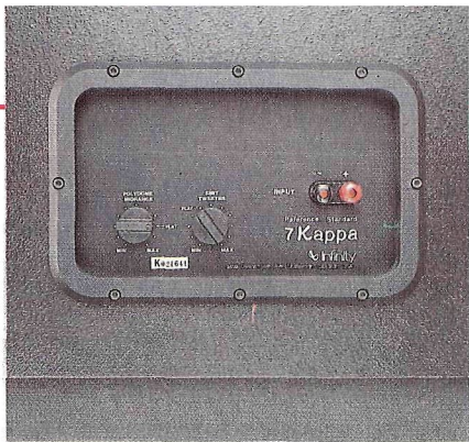
Il pannello su cui è fissato il crossover sostiene anche i morsetti di ingresso ed i due controlli di livello.
